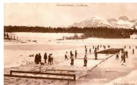
charrues, et de les empiler. Il fallait aussi, aux premières chaleurs, transporter en ville, dans des chars, les blocs isolés avec de la paille et enfermés dans des toiles en jute. Les pertes ne dépassaient guère plus de 20% du volume.
